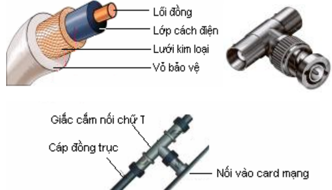
Hình 12.2. a) Cấu trúc của cáp đồng trục b) đầu cắm nối chữ T để nối máy tính vào mạng
