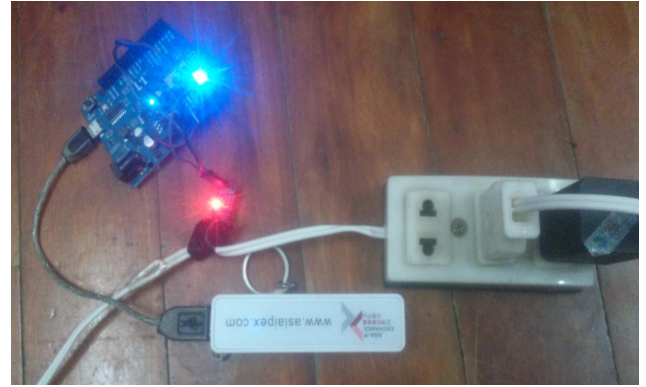
Hình 5 Hình ảnh ổ điện thông minh đã triển khai
