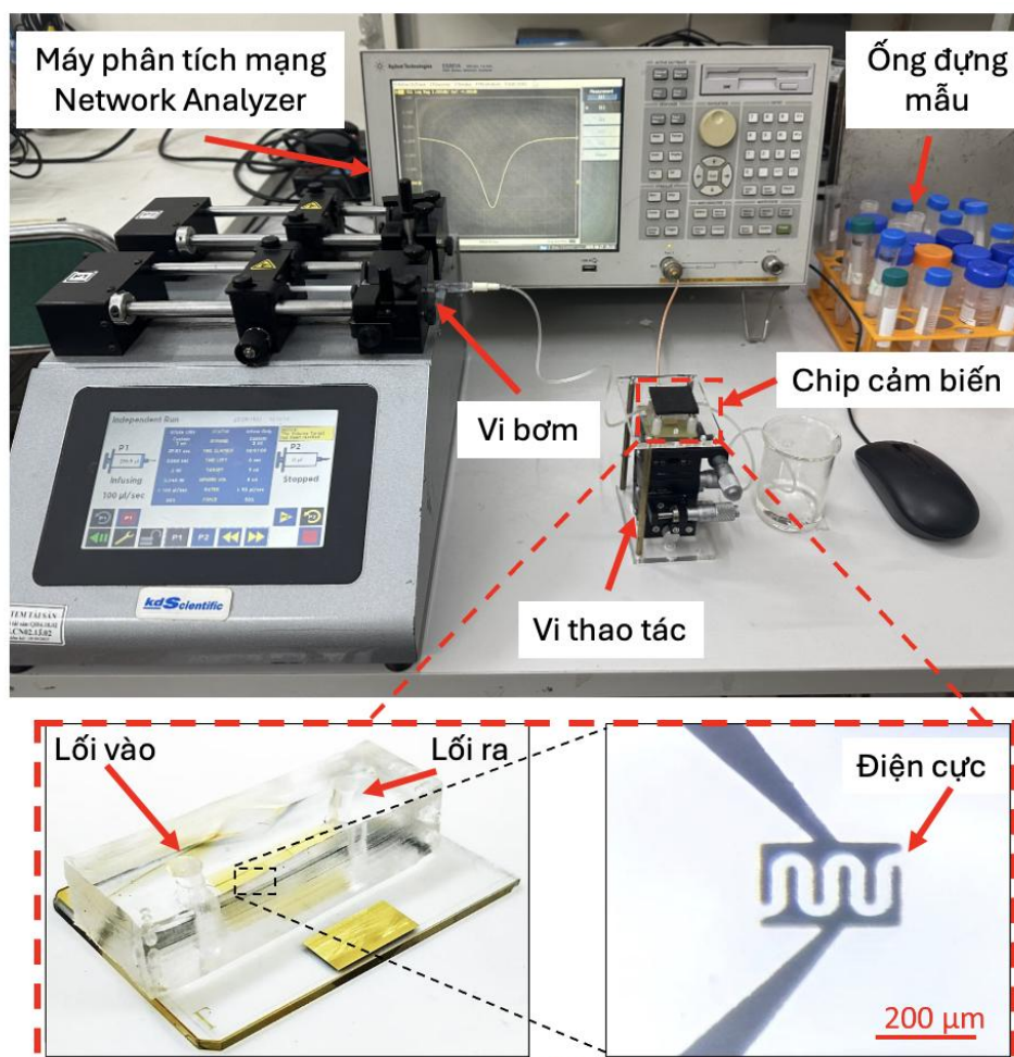
Hình 4.16. Thiết lập hệ thống đo lường để đánh giá hiệu năng của cảm biến tích hợp chip vi lưu với cấu trúc vi điện cực răng lược
